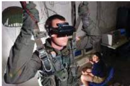
Gambar 1 Seorang perwira U.S. Navy menggunakan VR parachute trainer
